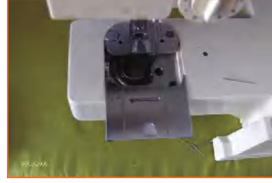
pj.k 8% अपनी मशीन पर निर्भर करते हुए दाएं से बाएं रील डालें। पर्याप्त धागे को खींचें जिससे जब सुई 5-10 इंच चले तो यह बाहर ना खिंचे।
