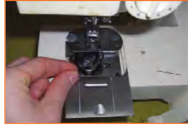
pj.k 9% धागे को बाहर तेजी से खींचें और रील को और ट्रे में सेट करें। धातु के खांचे में धागा डालें और वापस खींच लें।
